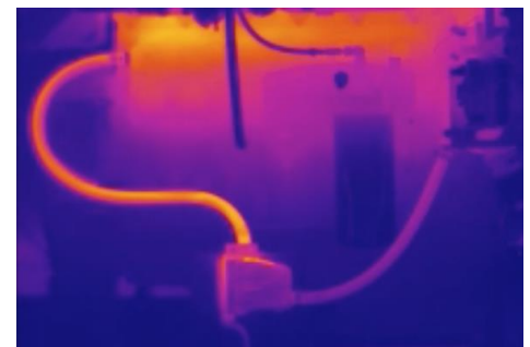
Punti incandescenti del riscaldatore a termosifone Temperatura di ebollizione
