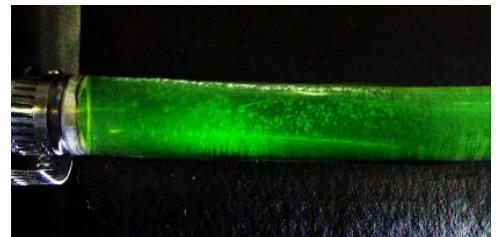
Ebollizione del refrigerante del riscaldatore con circolazione a termosifone
